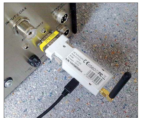
Bild 2: Der Bluetooth-Seriell-Adapter LM058 am seriellen Anschluss des Antennenkopplers Palstar AT-Auto Fotos: DK110
