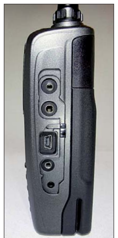
Anschlüsse satt: Außer Mikrofon-, Lautsprecher- und Ladebuchse gibt es noch eine serielle Schnittstelle und eine Mini-USB-Buchse für den einfachen Anschluss an den Computer.
