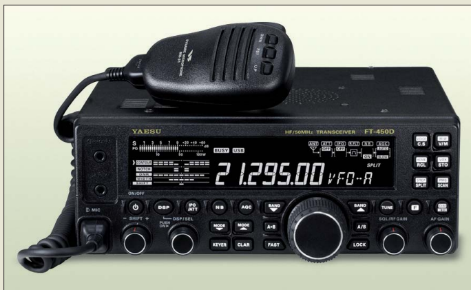
Der 100-W-Transceiver FT-450D besitzt als Standard einen eingebauten Antennentuner.
