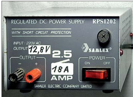
Bild 25: In dieses Gehäuse eines 2,5-A-CB-Funk-Netzteils mit den Abmessungen 130 mm x 80 mm x 170 mm (B x H x T) wurde zum Test das effiziente 18-A-Funk-Netzteil eingebaut. Foto: DL5BTE
