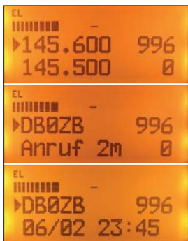
Bei Dualbandbetrieb können wahlweise Frequenzen oder Speicherplatznamen angezeigt werden. Bei nur einem Band werden stattdessen Datum und Uhrzeit eingeblendet.
