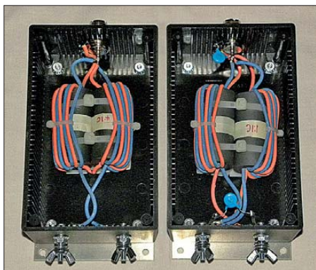
Bild 9: Innenansicht der beiden Baluns
