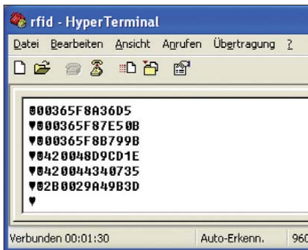
Bild 3: Die RFID-Codes werden hier über das Windows-Programm Hyper Terminal in den PC eingelesen.
