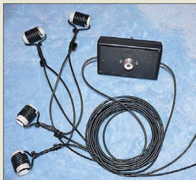
Der WARC-DG1DBM-Dipol ist mit verlustarmen Traps ausgestattet.
