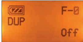
Akkufüllstandsanzeige, mittels Zweitfunktionstaste eingeleuchtet
