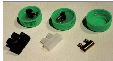
Schraubdeckel von Plastikflaschen sind Wegwerfartikel. Sie lassen sich jedoch gut als Drehknöpfe für Potenziometer verwenden.
