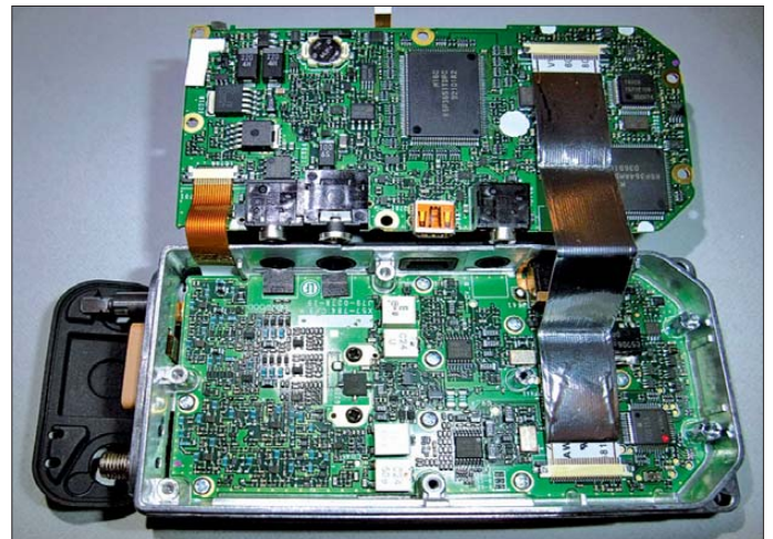
Zwischen den beiden schwarzen Schrauben liegt der Endstufentransistor.
