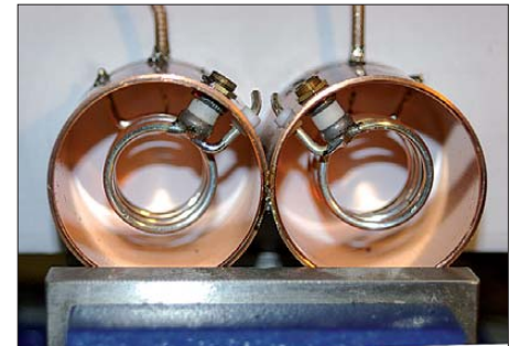
Bild 5: Ansicht des Filters mit der realisierten Überkopplung
