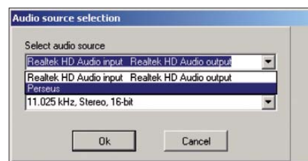
Bild 9: Dank der integrierten Steuerung für den Empfänger PERSEUS SDR dient dieser alternativ zur Soundkarte als Signalquelle. Screenshots: DE8JOI
