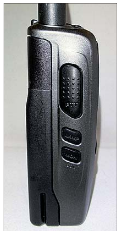
Die große Sendetaste liegt genau auf Daumenhöhe.
